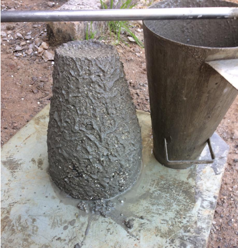
Figura 6- Imagem fotográfica representativa do ensaio de consistência realizado nas argamassas de concreto convencional e com adição de porcentagens de 60% e 70% de EPS e EVA.
