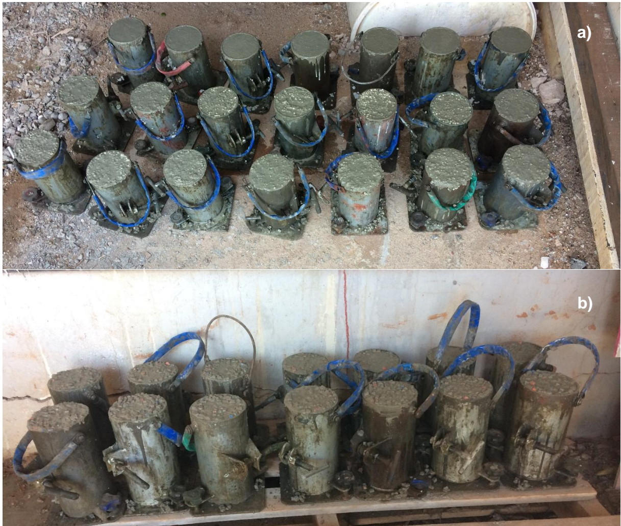
Figura 5 – a) Sete corpos de prova de concreto convencional e 14 corpos de prova de concreto leve com adição de EPS. b) 14 corpos de prova de concreto leve com adição de EVA.
