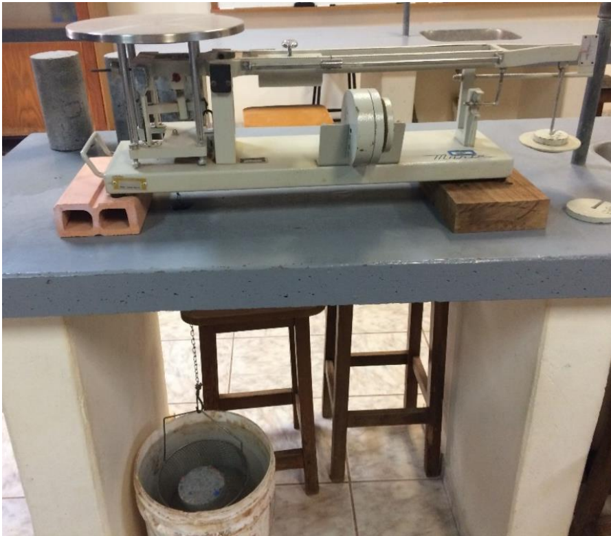
Figura 9 - Corpos de prova sendo pesados imersos em água na balança hidrostática.
