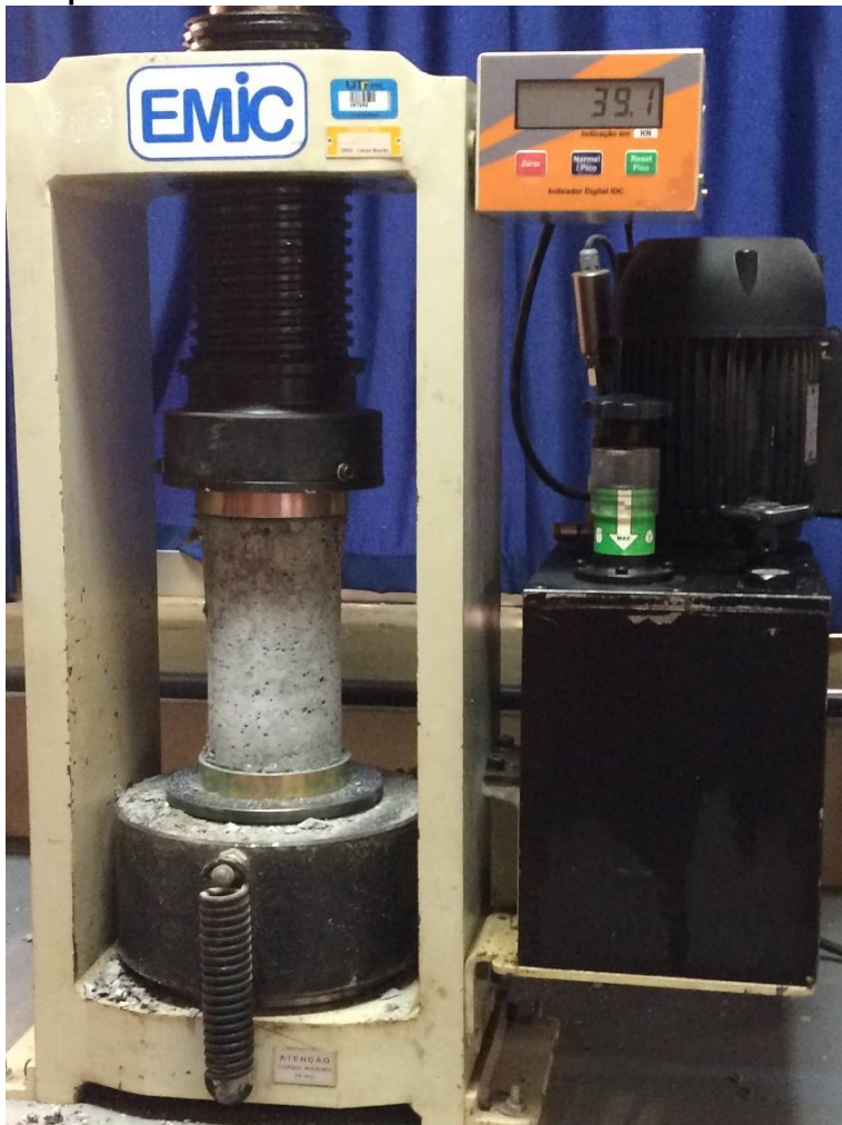
Figura 10 – Imagem fotográfica representativa da realização do teste de resistência a compressão.
