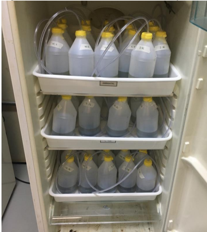
Figura 5: Reatores na estufa incubadora do tipo B.O.D.
