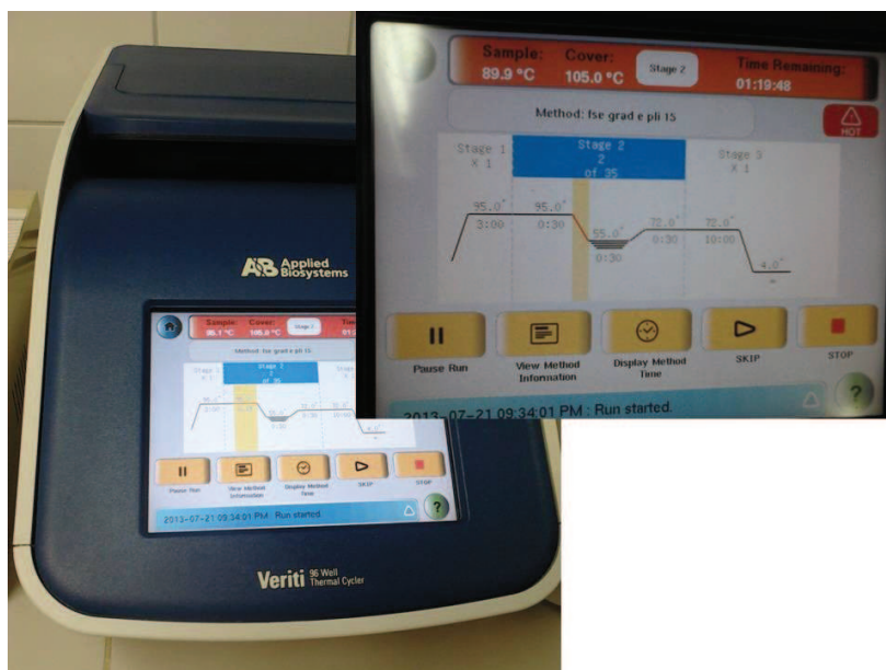
Figura 06 – Termociclador utilizado na amplificação das amostras de DNA e no detalhe o programa de amplificação utilizado. Fonte Martins, D.A.
