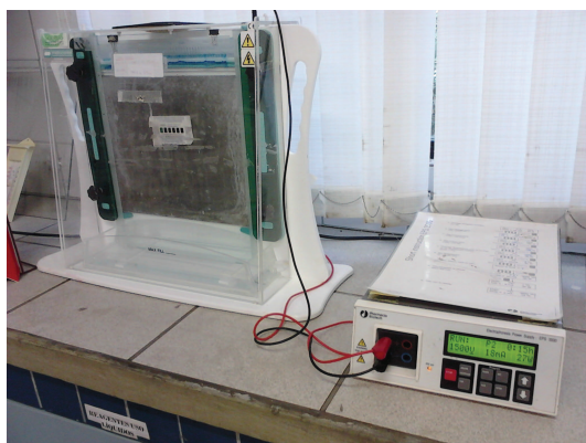
Figura 01A - Cuba e fonte utilizada para eletroforese em gel de poliacrilamida. Fonte: Martins, D.A.
