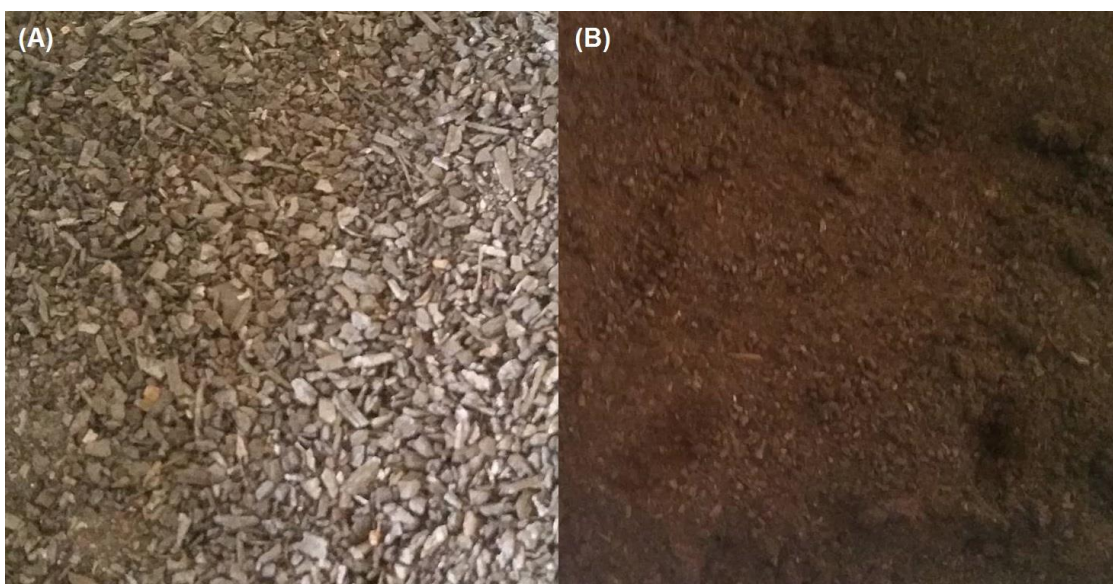
Figura 1. Biochars produzidos: A) Biochar de finos de carvão (madeira); B) Biochar de coco verde.
