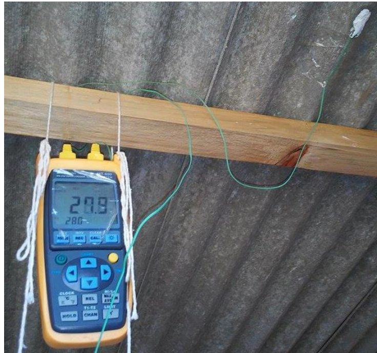
Figura 6 – Termômetro posicionado dentro de um dos protótipos, medindo a temperatura da telha, e a temperatura do ar interno.
