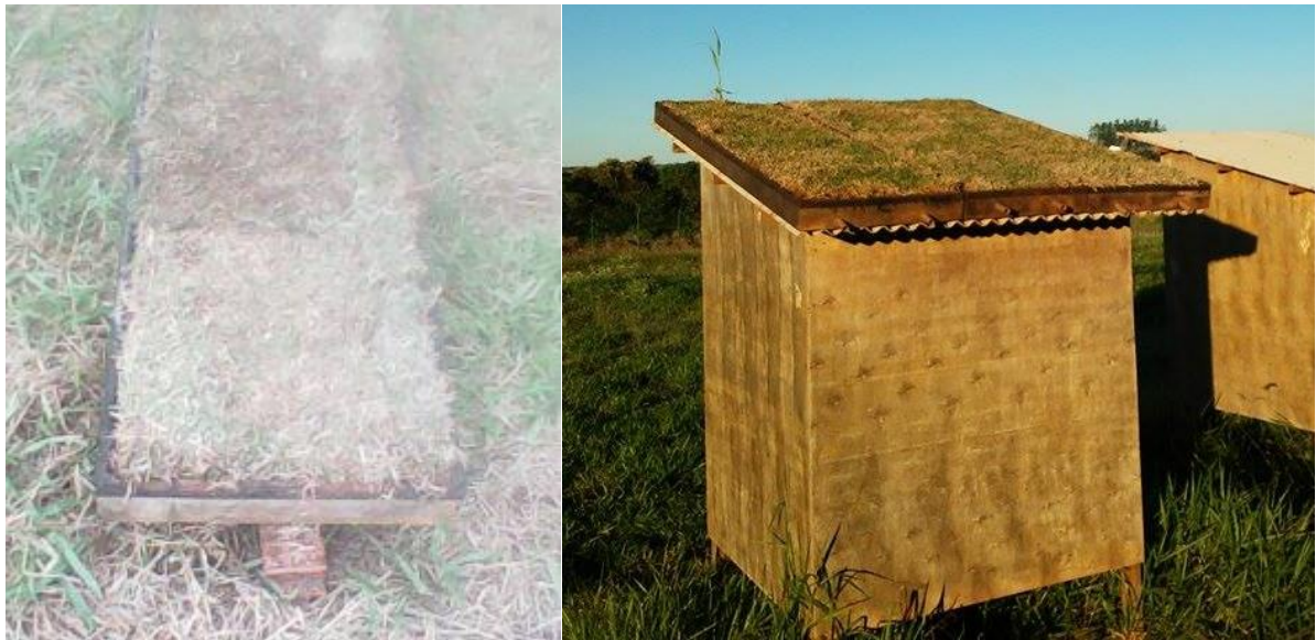
Figura 5 – a): Grama Esmeralda sobre um dos módulos de telhado verde, b) as placas de grama já adaptadas e sobre um dos cômodos.
