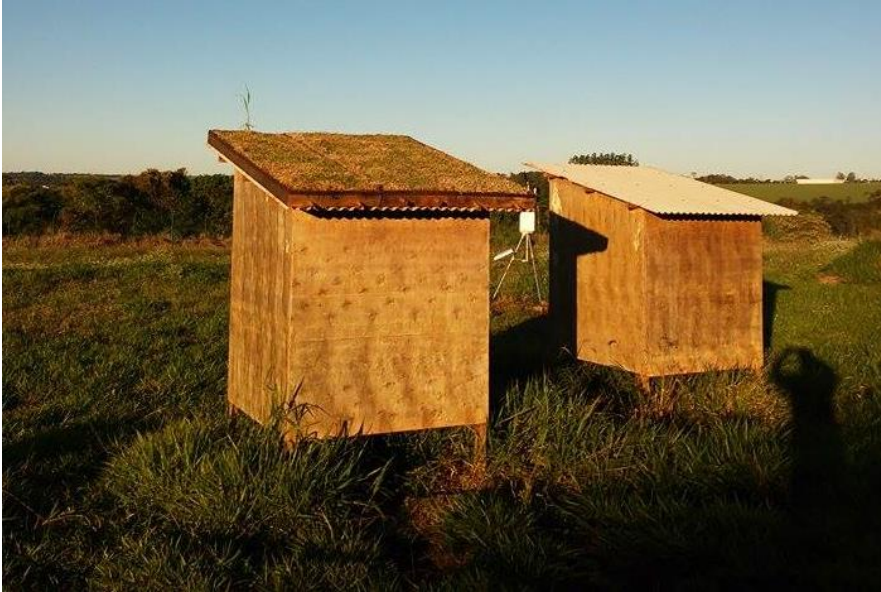
Figura 15 - O experimento com um cômodo revestido por cobertura verde, e outro apenas com telhas de fibrocimento. Ao fundo a Estação Meteorológica Automática do Campus.
