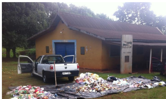
Figura 3 - Disposição dos resíduos sólidos gerados na Vila Rural para a homogeneização e separação.
