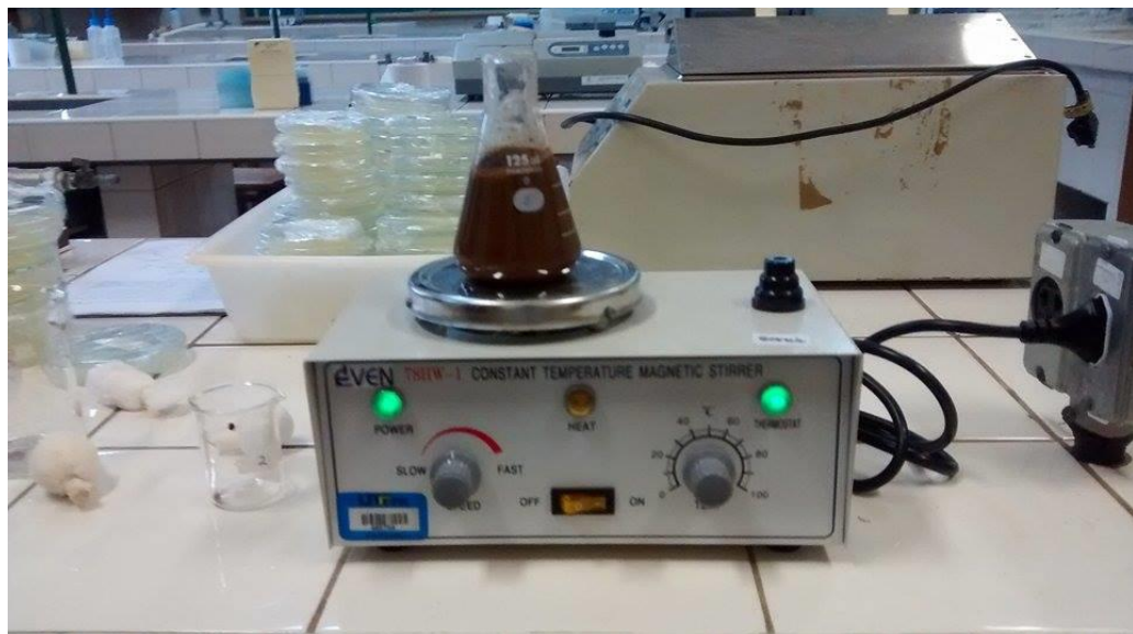
Figura 5 - Preparação das amostras de solo.
