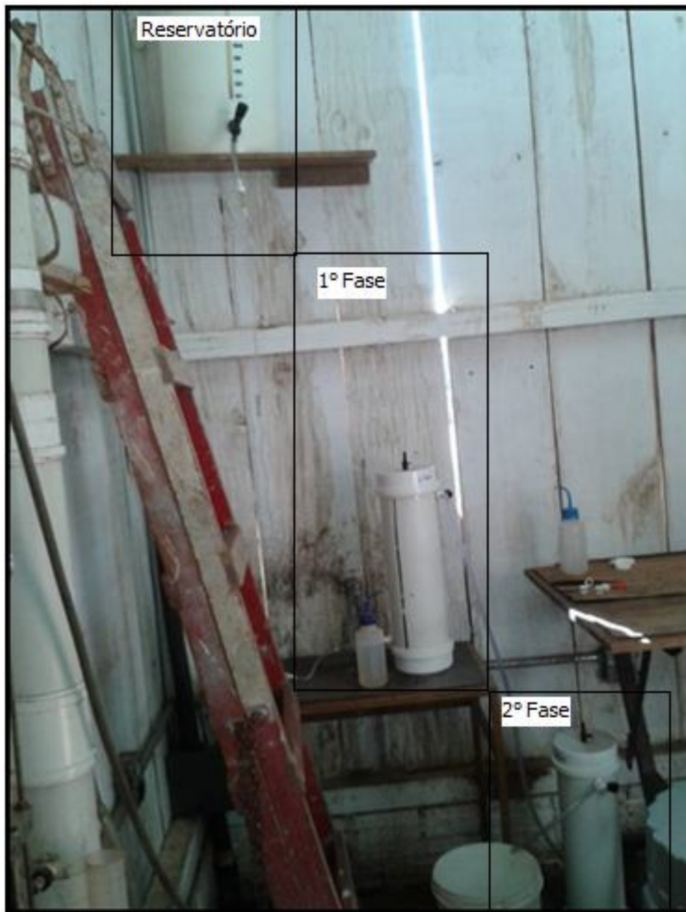
Figura 3: Protótipo do sistema de tratamento de manipueira, montado e em funcionamento.
