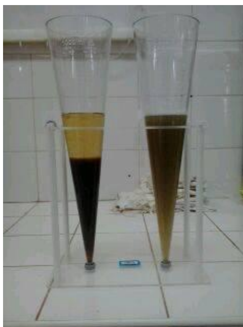
Figura 9. Cones de Imhoff no ensaio de determinação do volume de lodo. A direita o coagulante PAC e à esquerda o coagulante Tanino
