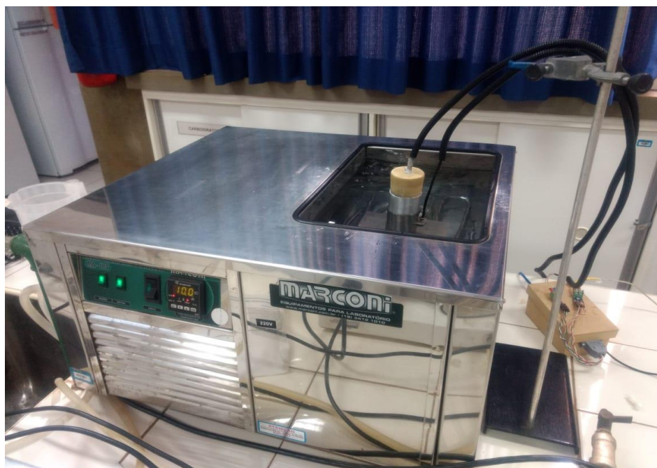
Figura 2 – Banho termostático contendo o conjunto tubo e amostra conectado ao sistema de aquisição de dados.
