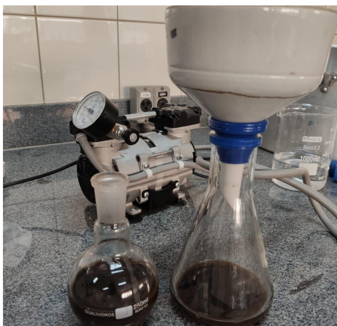
Figura 5: Procedimento de filtração a vácuo
