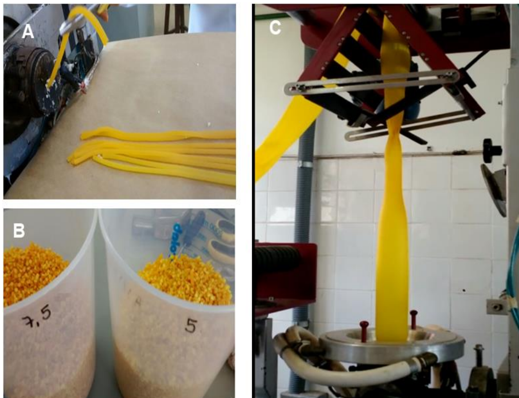
Figura 7. Etapas de elaboração dos filmes. A- Peletes B- Peletes Triturados C- Balão formado durante a extrusão-sopro.
