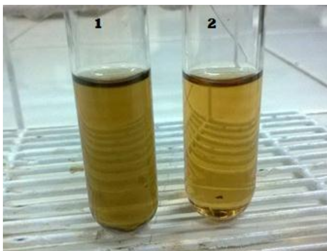
Figura 2 -Preparo do substrato (1) sem ultrafiltração e tratamento (2) com ultrafiltração.
