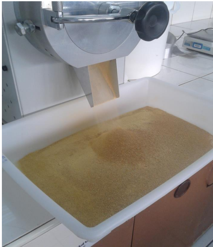
Figura 9 - Farinha da Casca da Poncã, após trituração em moinho de facas.
