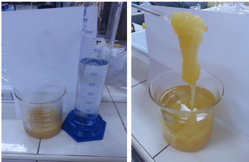
Figura 7 - Adição de dois volumes de etanol ao filtrado e formação de precipitado.
