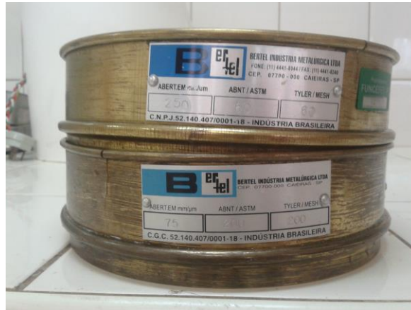
Figura 10 - Peneiras utilizadas para padronização da farinha da casca da Poncã.
