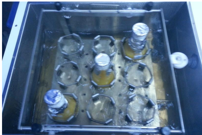
Figura 16 - Extração com aquecimento e agitação vigorosa.
