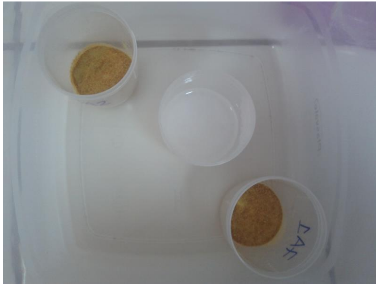
Figura 3 - Exemplo de ambiente com solução saturada e amostra para determinação de comportamento higroscópico da farinha da casca de poncã.
