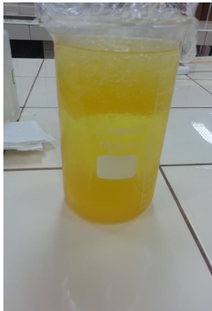
Figura 18 – Precipitado de pectina formado utilizando extração com sonificador.
