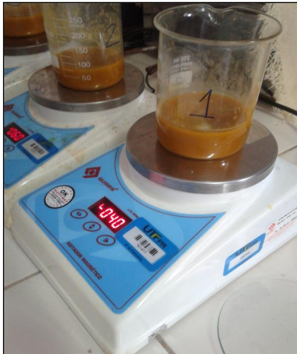
Figura 2- Fase inicial da extração de lipídios por metodologia de Bligh & Dyer. Agitação da amostra com clorofórmio, metanol e água.
