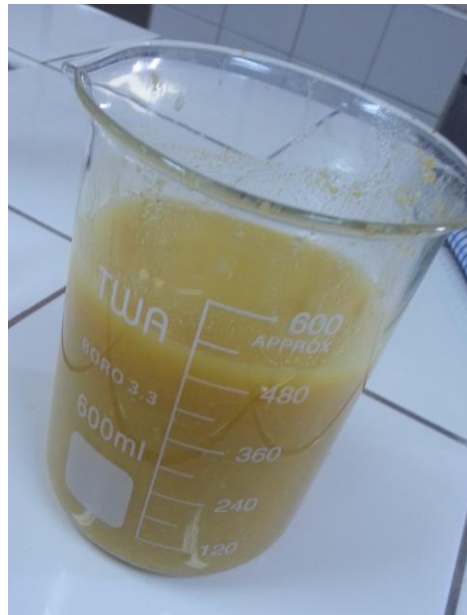
Figura 5 - Suspensão da Farinha da casca de poncã em água acidificada.
