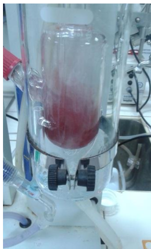
Figura 4: Análise de açúcares redutores em melado empregando-se o equipamento DETERMINADOR DE AÇUCARES REDUTORES, TECNAL. TE-088.
