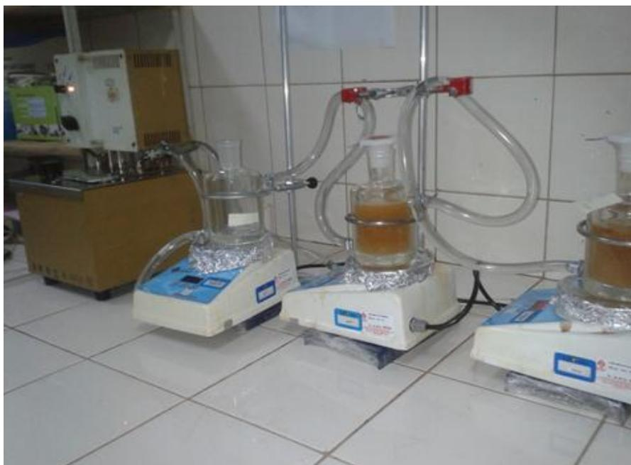
**FIGURA 3:** Processo de extração da pectina em reator.
