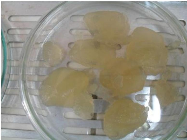
**FIGURA 5:** Pectina precipitada obtida após a centrifugação
