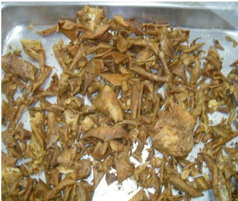
**FIGURA 4:** Casca do maracujá seca em estufa de circulação de ar à 70 °C por 24 horas utilizada nos ensaios
