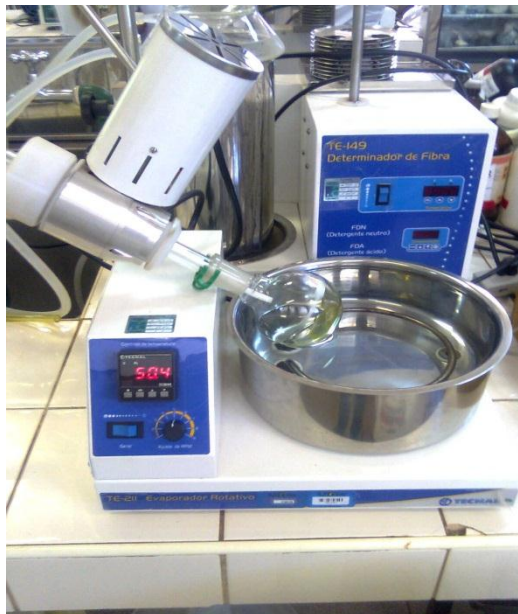
Foto 3: Evaporador rotativo utilizado para a extração de taninos
