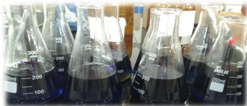
Figura 7- Coloração obtida após a adição da solução indicadora de amido. Fonte: Autoria própria, (2018).
