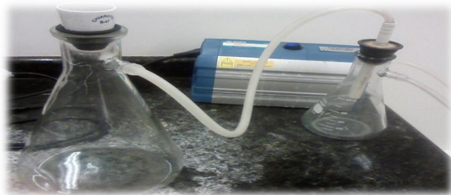
Figura 5- Sistema de filtração utilizado na filtragem das amostras.
