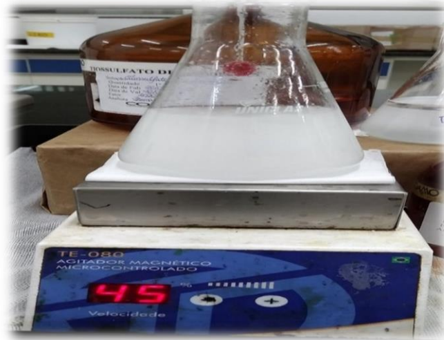
Figura 8- Ponto final da titulação do iodo com tiosulfato de sódio. Fonte: Autoria própria, (2018).
