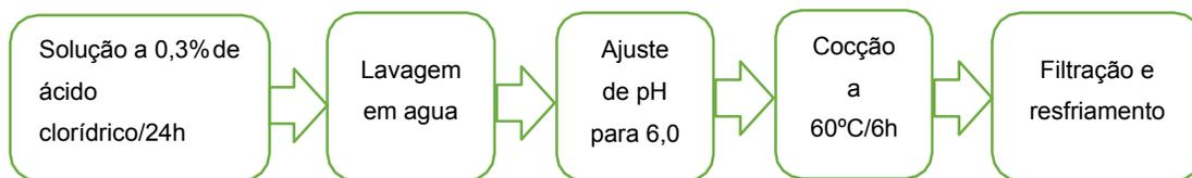
Figura 1: Pré-tratamento ácido realizado com ácido clorídrico
