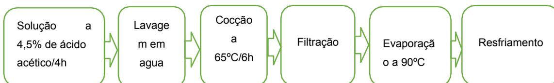
Figura 3: Pré-tratamento ácido realizado com ácido acético e processo de evaporação.
