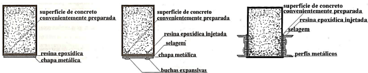
Figura 5 - Reforço com chapas metálicas coladas, chumbadas e com perfis metálicos.
