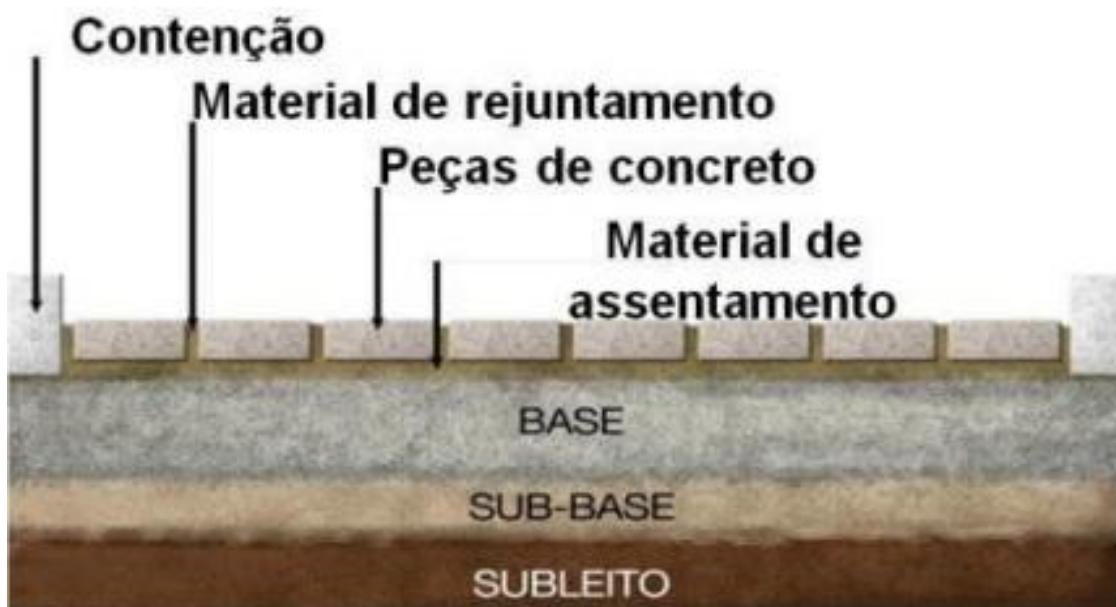
FIGURA 4- Esquema de aplicação de pavimentos intertravados.
