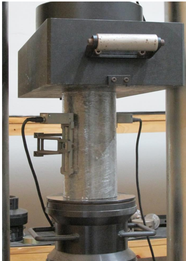
Figura 11 - Corpo-de-prova com extensômetro Fonte: Autoria própria
