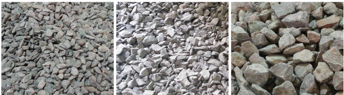
Figura 5 - Amostra de cada tipo de agregado graúdo lavado e seco em estufa
