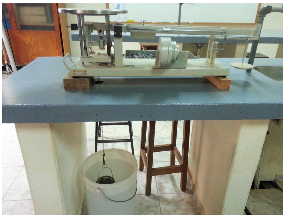
Figura 7 - Ensaio para determinação de massa específica real do agregado graúdo Fonte: Autoria própria
