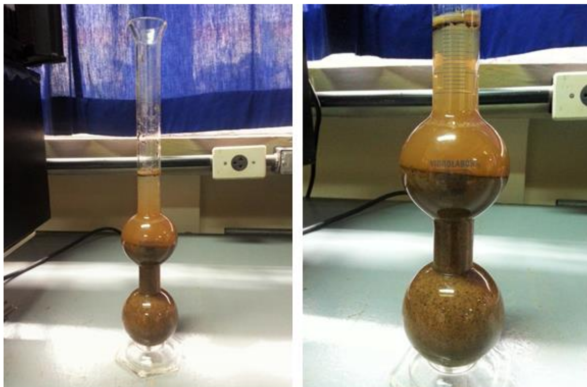
Figura 8 - Frasco de Chapman na determinação da massa específica real do agregado miúdo Fonte: Autoria própria
