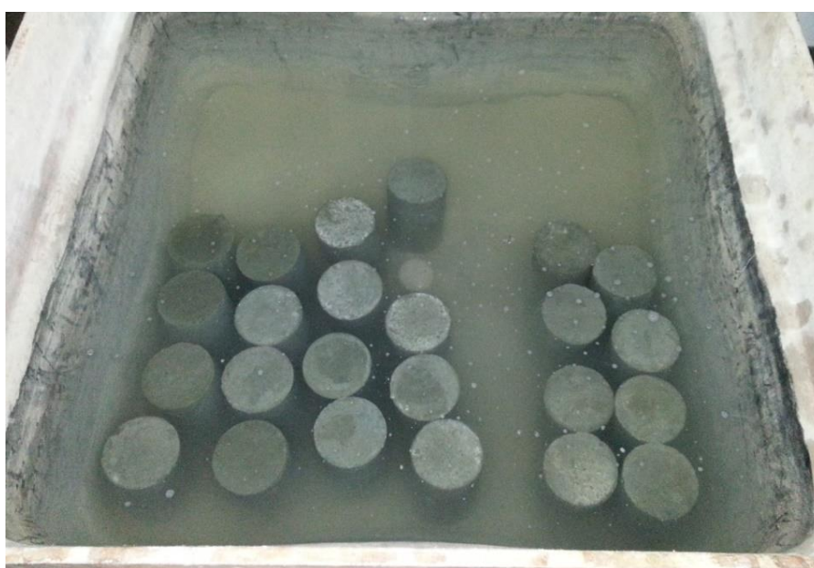
Figura 9 - Corpos-de-prova armazenados em solução saturada de hidróxido de cálcio Fonte: Autoria própria
