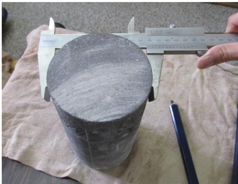
Figura 10 - Medição do diâmetro dos corpos-de-prova com paquímetro Fonte: Autoria própria
