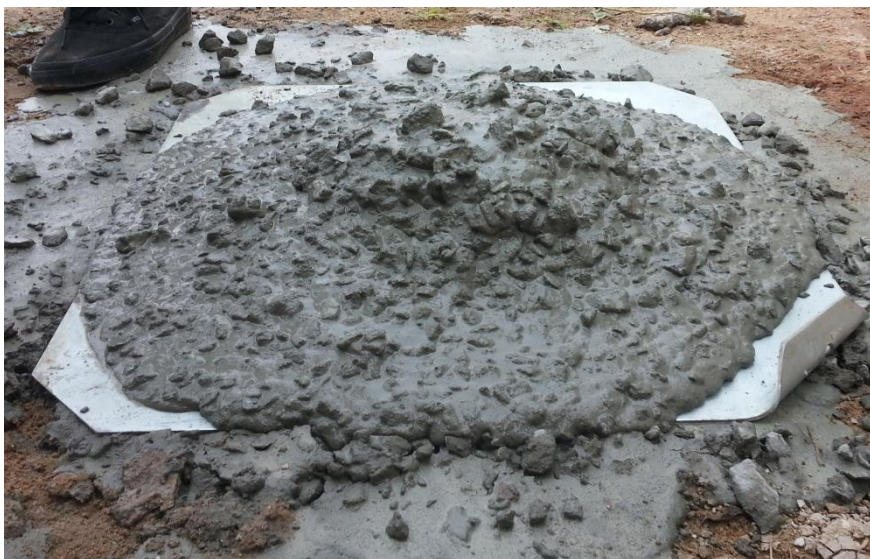
Figura 13 - Resultado do ensaio do abatimento do tronco de cone Fonte: Autoria própria
