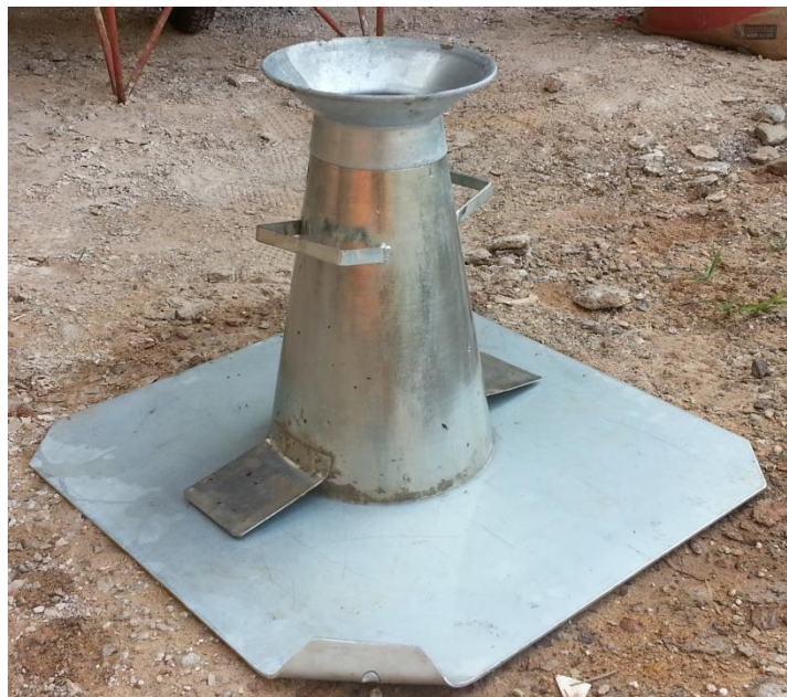
Figura 12 - Materiais utilizados para o ensaio do abatimento do tronco de cone Fonte: Autoria própria
