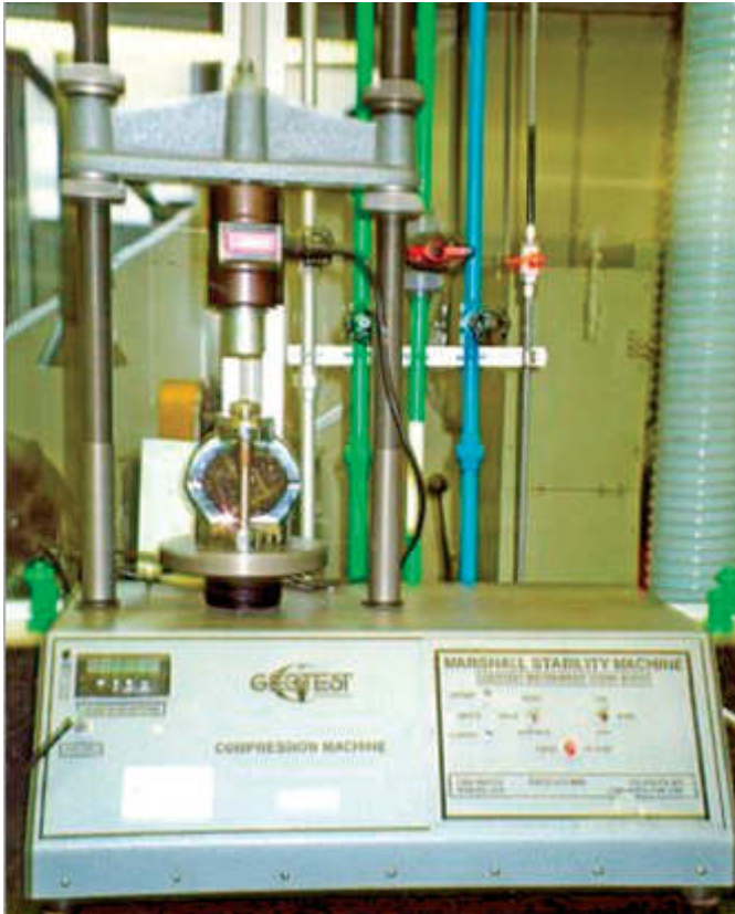
Figura 2–Equipamento: Realização de ensaio de estabilidade Marshall
