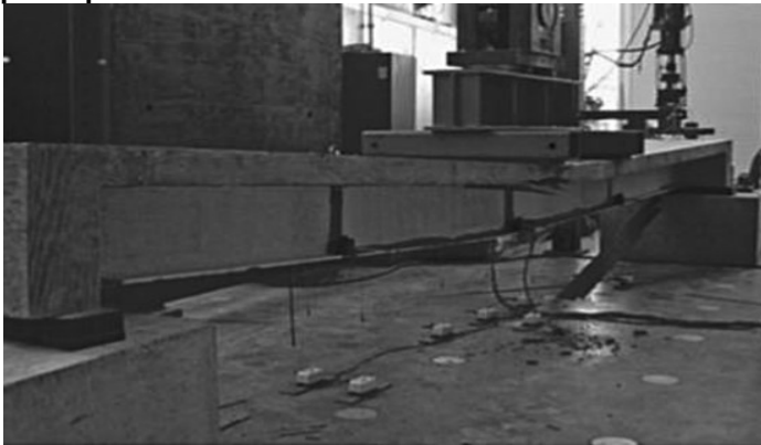
Figura 12 – Falha de flexão no plano de uma viga mista de aço e concreto reforçada com PRF por ruptura do PRF
