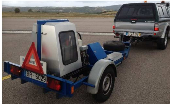
Figura 3.2 - Exemplo de deflectômetro de impacto, Dynatest FWD.
