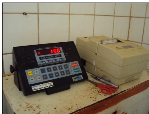
Figura 8 – Balança eletrônica com emissão de recibo de pesagem. Fonte: Autoria própria, (2015).
