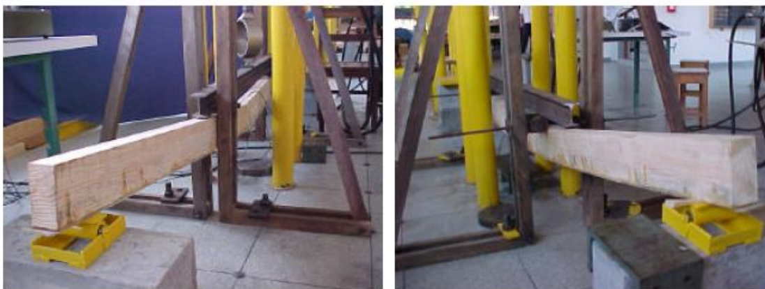
Figura 27 - Flecha acentuada na viga reforçada Fonte: Fiorelli (2002)
