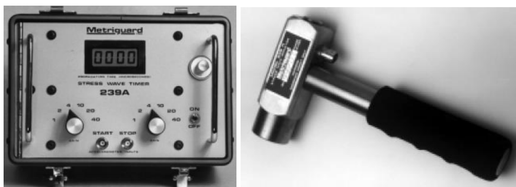
Figura 9 – Componentes do aparelho METRIGUARD: À esquerda, unidade central. À direita, martelo de impacto. Fonte: Júnior (2006).
