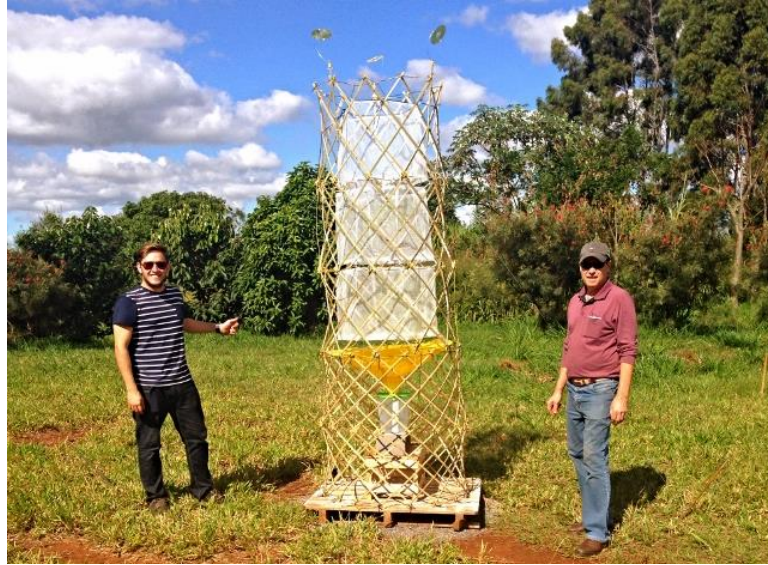
Figura 12 - Protótipo Warka Water, construído na escala 1:4 Fonte: A autoria própria (2015)
