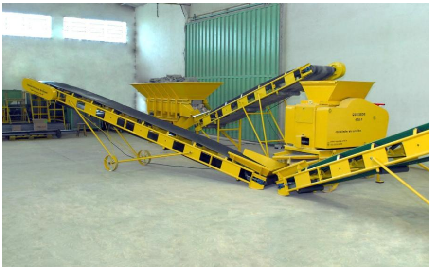
Figura 15 - Conjunto para a reciclagem de RCC
