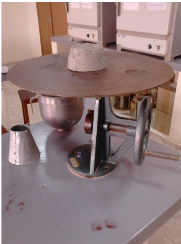
Figura 5 - Corpo de prova pra o ensaio índice de consistência.
