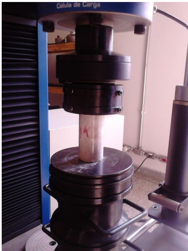
Figura 8 - Ensaio de resistência a compressão do corpo de prova cilíndrico.
