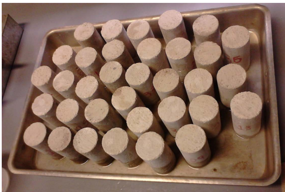
Figura 9 - Ensaio de absorção de água com corpos de prova cilíndricos.
