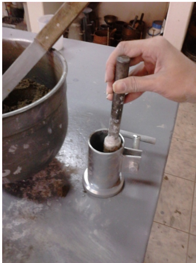
Figura 7 - Montagem do corpo de prova cilíndrico.
