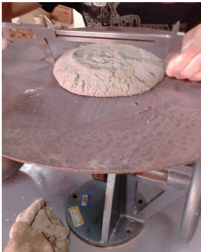
Figura 6 - Corpo de prova do índice de consistência após ser ensaiado.
