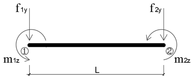
Figura 5 - Esforços equivalente para um elemento de barra submetido a carregamento distribuído Fonte: Autoria própria
