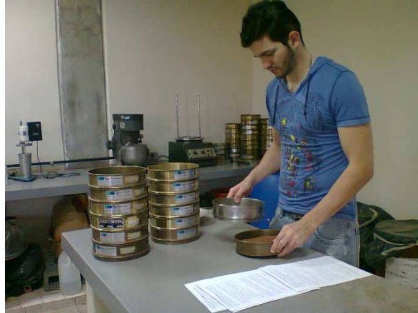
Figura 42 – Realização do ensaio de granulometria por peneiramento
