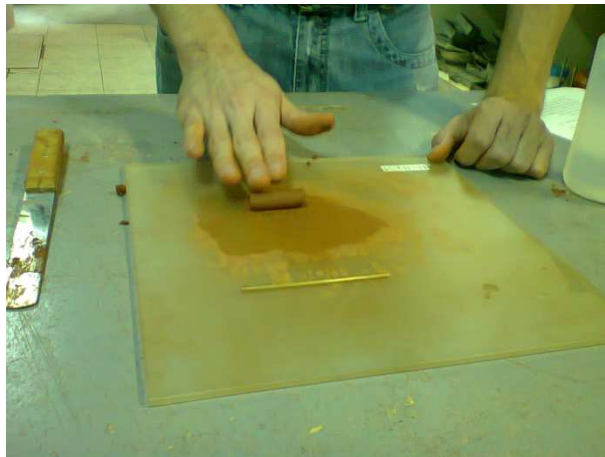
Figura 41 – Realização do ensaio de limite de plasticidade
