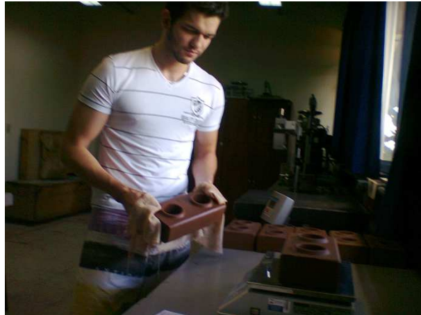
Figura 45 – Ensaio de absorção de água
