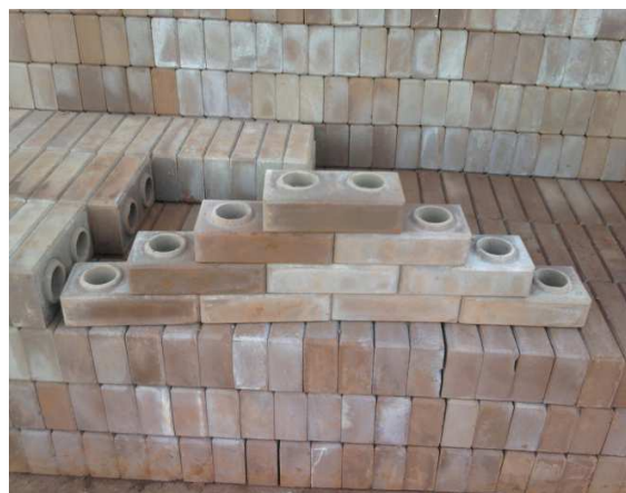
Figura 50 – Aparência dos blocos solo-cimento
