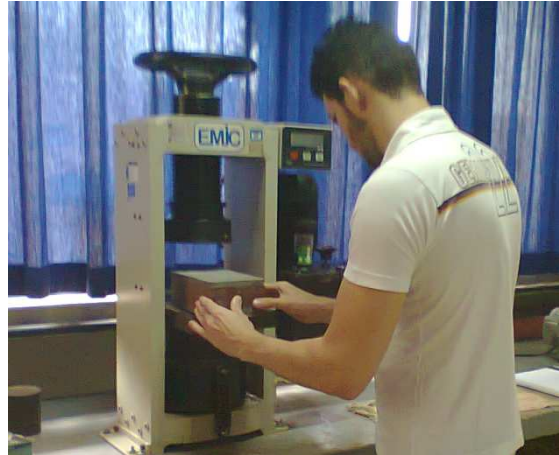
Figura 44 – Ensaio de resistência à compressão simples
