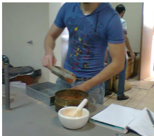
Figura 39 – Preparação da amostra de solo
