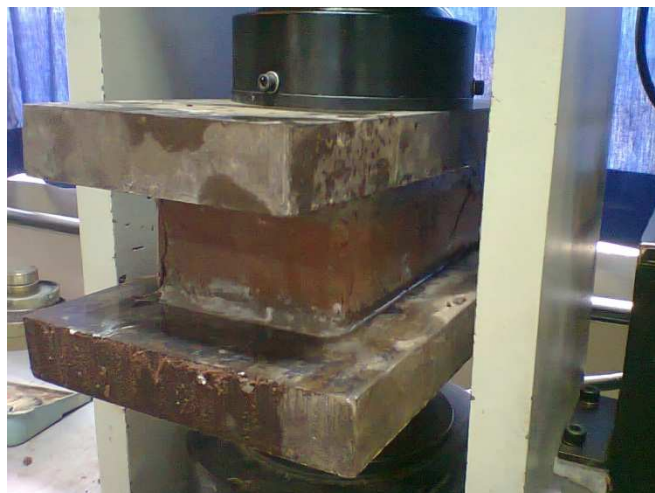
Figura 49 – Rompimento do bloco solo-cimento
