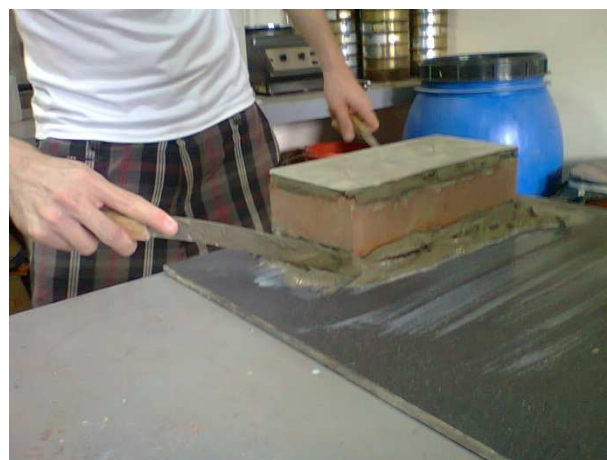
Figura 43 – Capeamento do bloco solo-cimento
