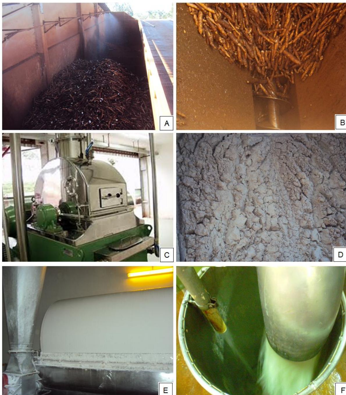
Figura 2 – Recepção e higienização das raízes de mandioca (A); descascamento (B); fragmentação na moenda (C); bagaço de onde é extraída a farinha (D); filtro rotativo à vácuo para extração da fécula (E) e manipueira gerada no processo (F).
