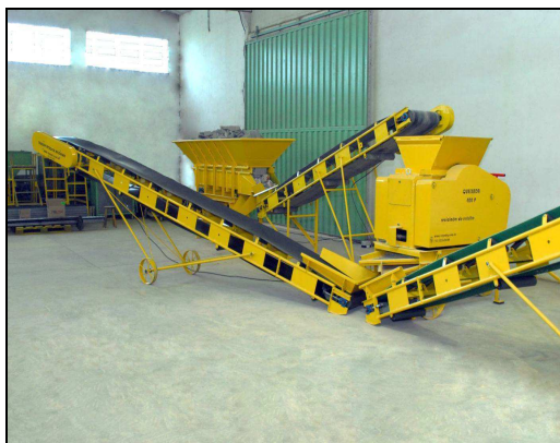
Figura 4 - Conjunto Q400 produz 4-5m 3 /h em duas frações Fonte: Catálogo cedido pela empresa VEGEDRY
