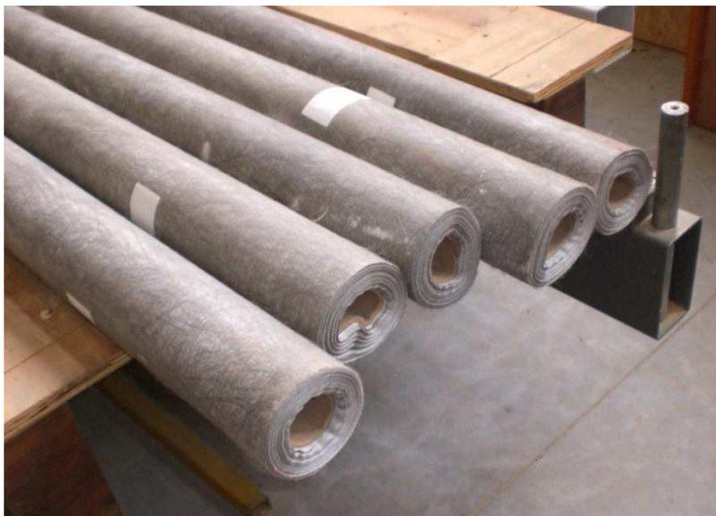
**Figura 31 - Membrana hidrófuga**
