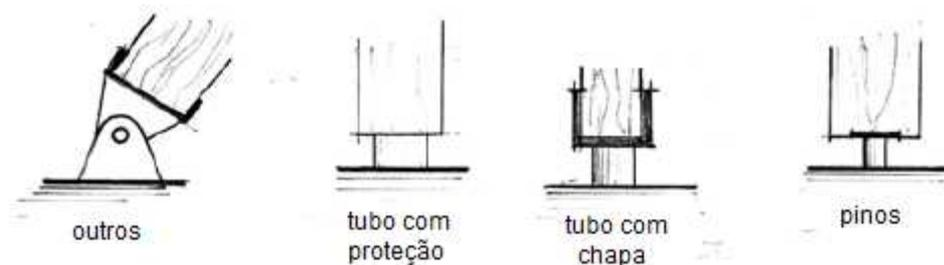
**Figura 26 - Tipos de apoios para evitar a umidade**
