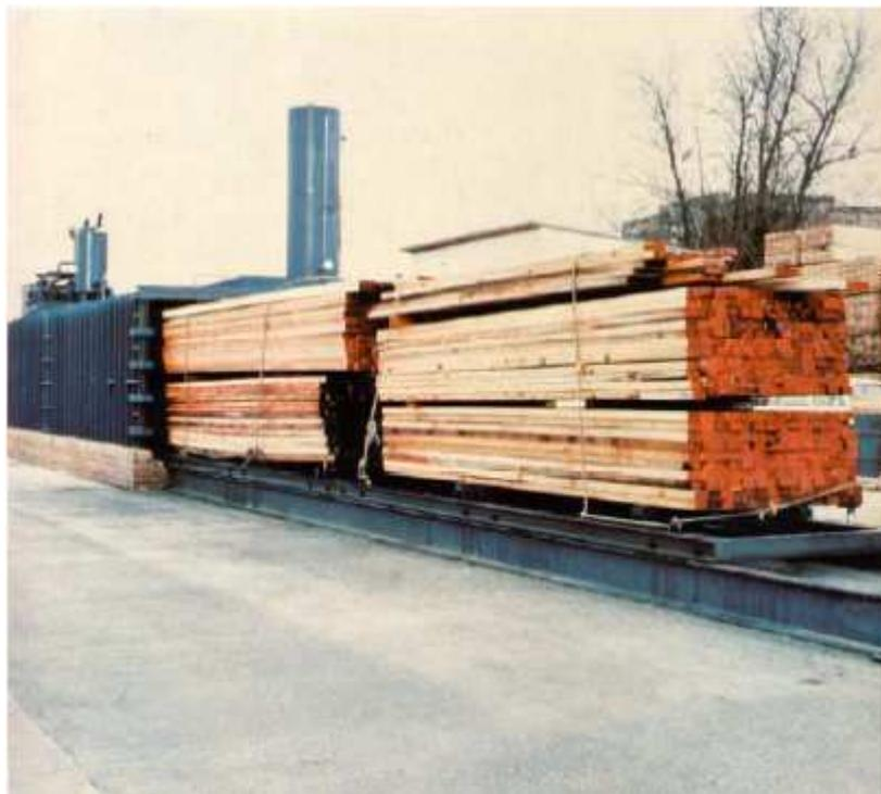
**Figura 24 - Planta de tratamento com autoclave de seção transversal retangular, utilizada para o tratamento por processo duplo-vácuo**
