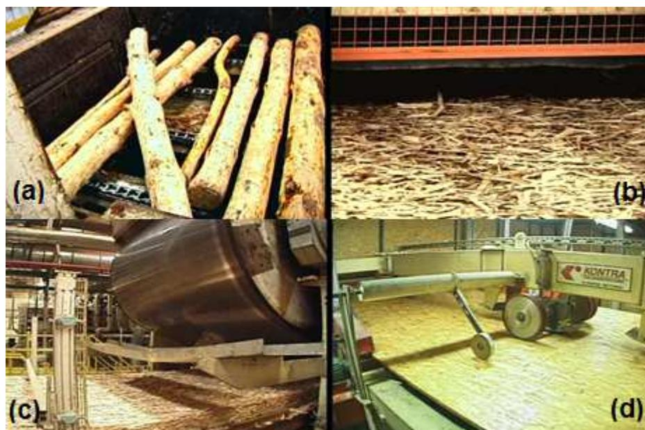
**Figura 7 - Processo de fabricação do OSB: (a) toras a serem descascadas e cortadas; (b) tiras; (c) colchão entrando na prensa; (d) saída das chapas prontas**
