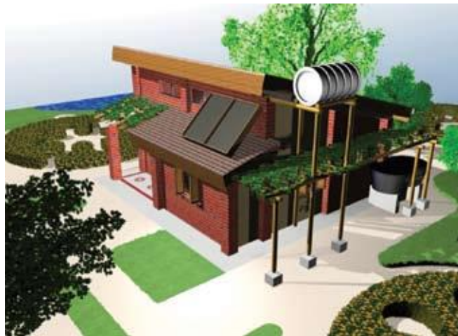
Figura 6 – Disposição das placas e reservatório do coletor solar. Fonte: Sattler (2007, p. 94).
