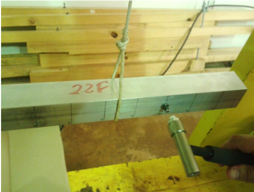
Figura 14 – Excitação da viga no ensaio de vibração transversal livre
