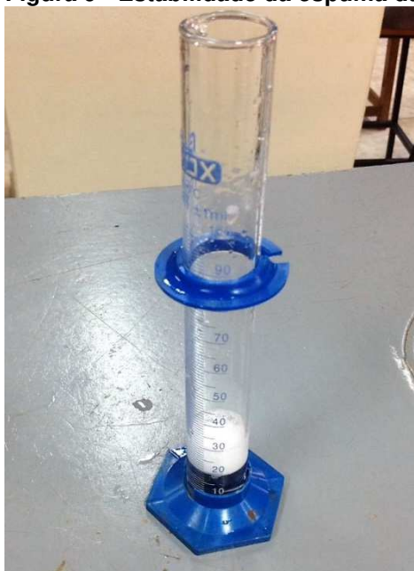
Figura 9 - Estabilidade da espuma da solução com aditivo comercial
