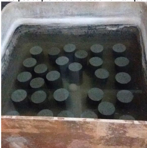
Figura 13 - Corpos de prova submersos em um tanque de água
