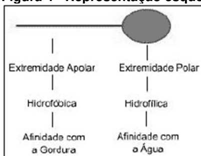
Figura 4 - Representação esquemática de um tensoativo
