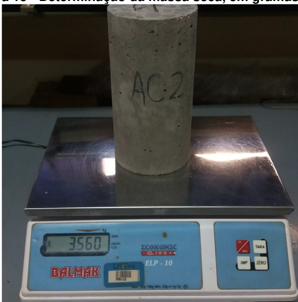
Figura 15 - Determinação da massa seca, em gramas, do corpo de prova
