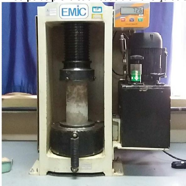
Figura 14 - Corpo de prova submetido a uma força de compressão
