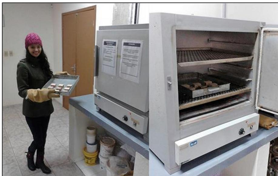
**Figura 18 – Disposição dos corpos de prova para determinação da umidade e densidade aparente**
