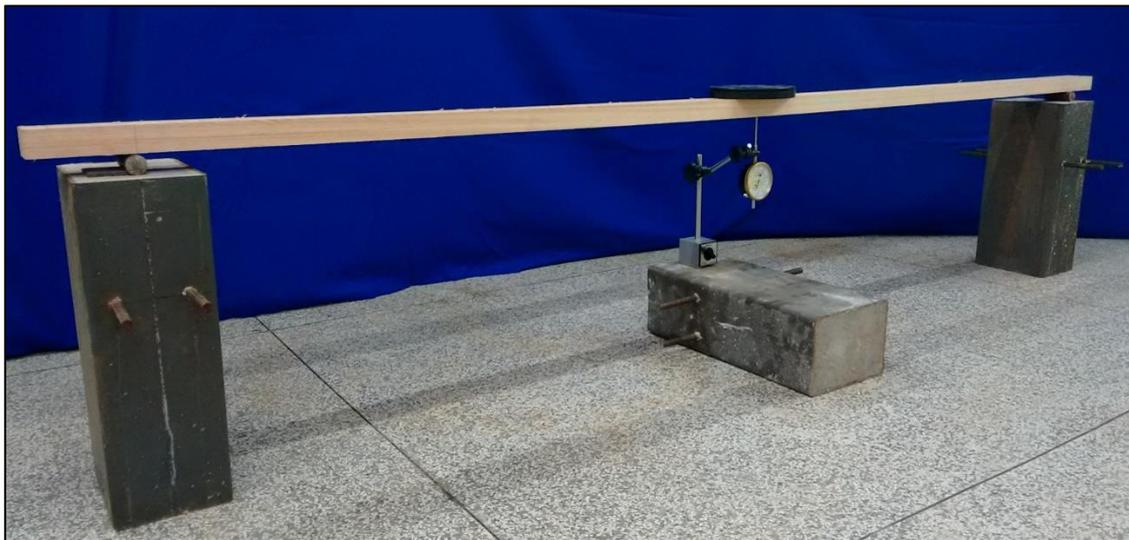
**Figura 19 - Ensaio de flexão estática das mesas**
