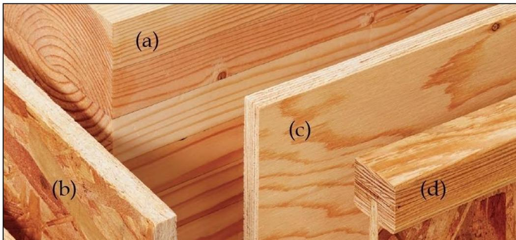
**Figura 1 – Produtos engenheirados de madeira (a) MLC, (b) OSB, (c) LVL e (d) “I-Joist”
