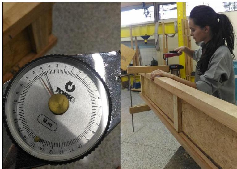
**Figura 24 – Aplicação de pressão de colagem**
