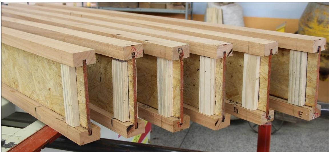
**Figura 25 – Vigas “I-Joists” finalizadas**
