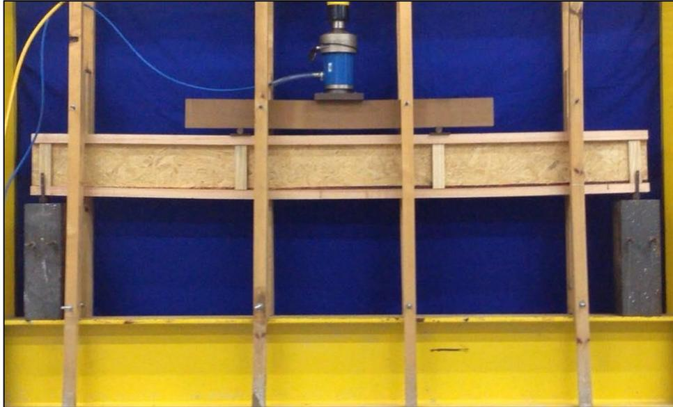
**Figura 27 – Contraventamento das vigas durante ensaio de flexão**
