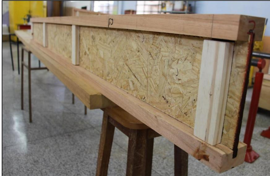
**Figura 26 – Enrijecedores instalados ao longo do comprimento das “I-Joists” nos pontos de aplicação de carga**
