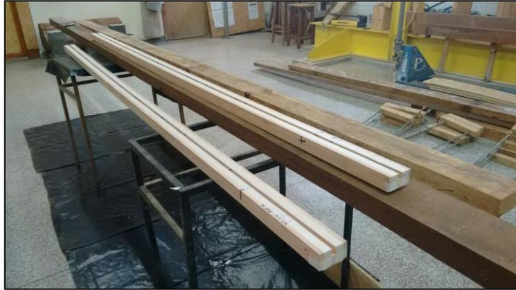
**Figura 23 – Preparação para colagem das “I-Joists”**
