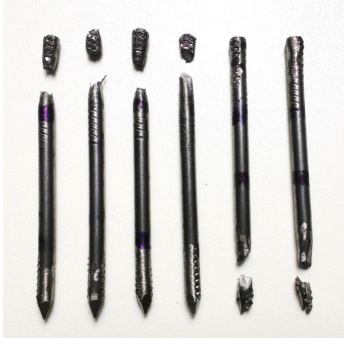
Figura 14 Pregos rompidos após o ensaio Fonte: Maia (2016)
