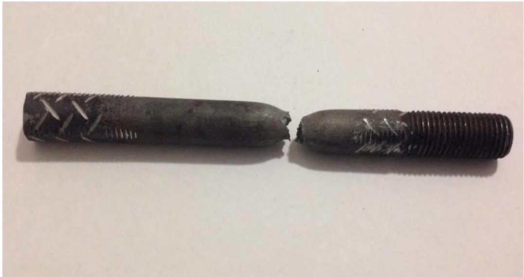
Figura 15 Parafuso rompido após a realização do ensaio Fonte: Silva e Góes (2015)
