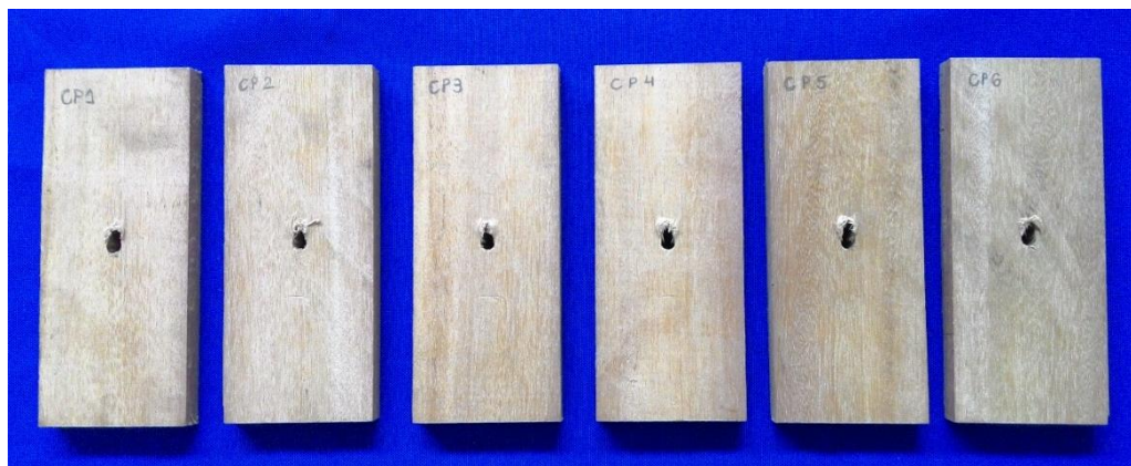
Figura 13 Corpos de prova após o ensaio de resistência ao embutimento para madeira Garapeira (Pregos) Fonte: Maia (2016)
