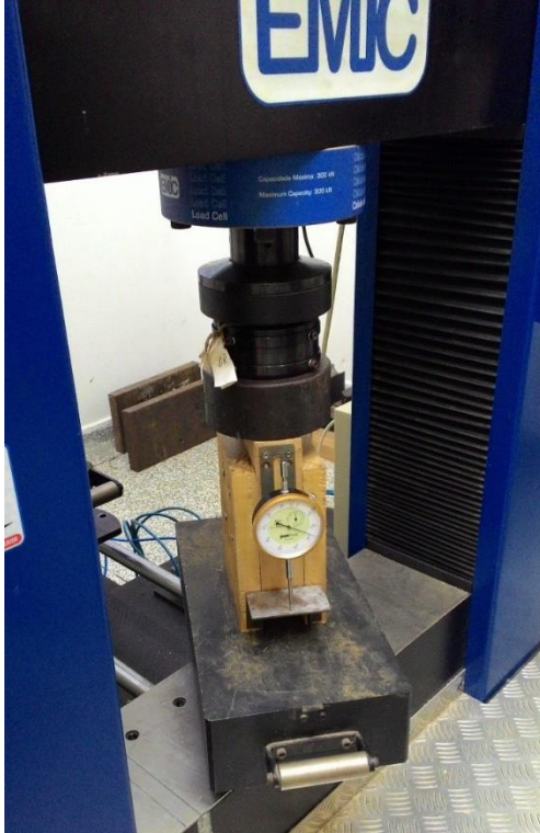
Figura 19 Procedimento de carga do ensaio de obtenção da rigidez de ligações Fonte: Maia (2016)
