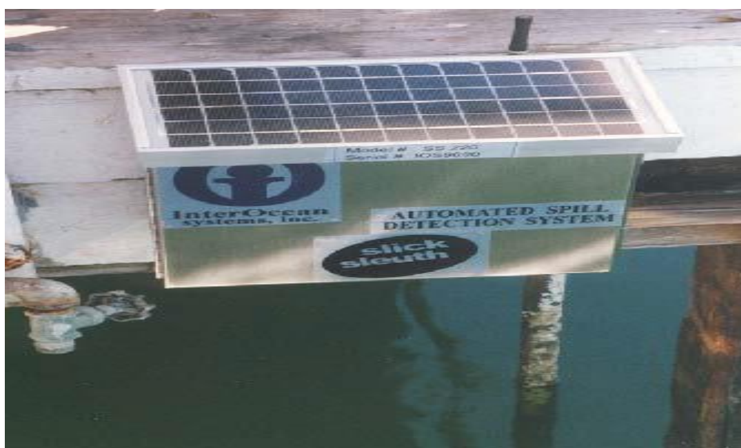
Figura 12: Sensor Slick Sleuth™ com células fotoelétricas e comunicação por rádio frequência.
