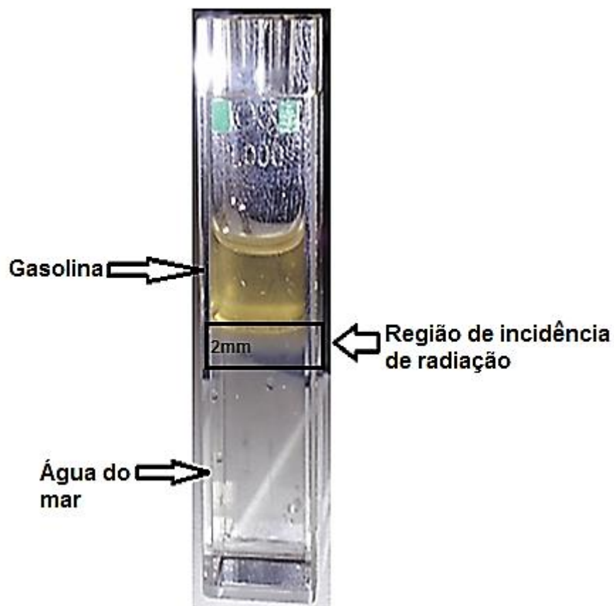
Figura 31: Cubeta de quartzo com água do mar e gasolina. É possível observar uma maior turbidez na água na região de incidência apresentada nesta figura, esta alteração acontece quando adicionado gasolina na água do mar.
