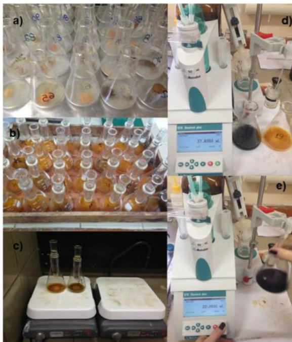
Figura 2 - Etapas principais do método da oxidação com dicromato de potássio empregado como referência nas análises de carbono orgânico no solo: a) pesagem das amostras de solo; b) digestão das amostras com solução de dicromato de potássio; c) digestão a quente; d) adição do indicador difenilamina; e) titulação do excesso de dicromato com solução de sulfato ferroso amoniacal.
