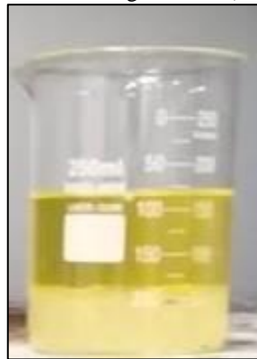
Figura 16: Separação das frações do óleo de frango: oleína (fase superior) e estearina (fase inferior).
