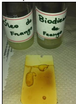
Figura 19: Placa cromatográfica de sílica gel com aplicações de óleo de frango (material de partida da reação) e biodiesel, eluída em solução de éter de petróleo e etanol (2:1) e revelada em cuba de iodo.
