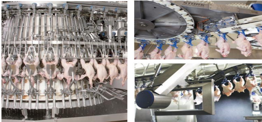
Figura 10: Etapas de evisceração, pesagem e classificação no processo industrial de abate de frangos de cortes.
