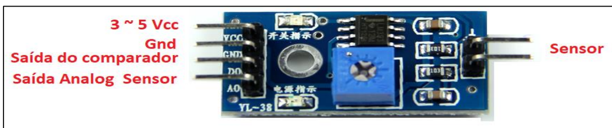
Figura 19 - Comparador de tensão YL-38.
