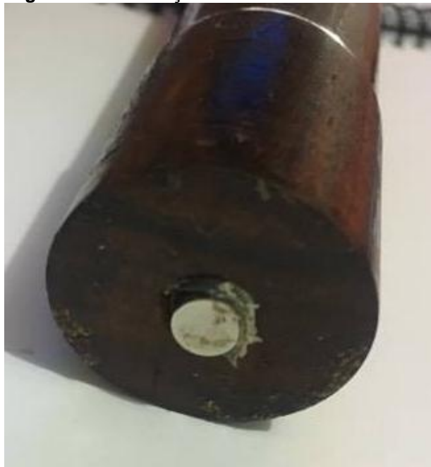
Figura 27 – Instalação do Ímã.
