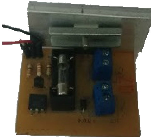
Figura 33 – Placa de acionamento da bomba.
