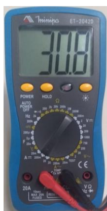
Figura 33: Consumo de corrente do simulador.
