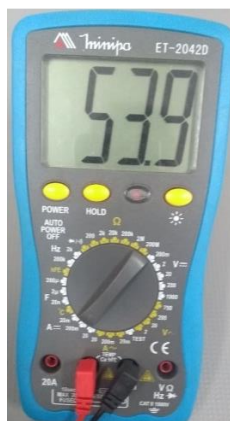
Figura 34: Consumo de corrente do holter
