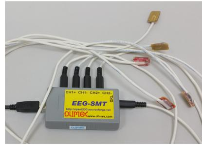
(b) Equipamento Olimex EEG-SMT com eletrodos (passivo/ativos) plugados.
