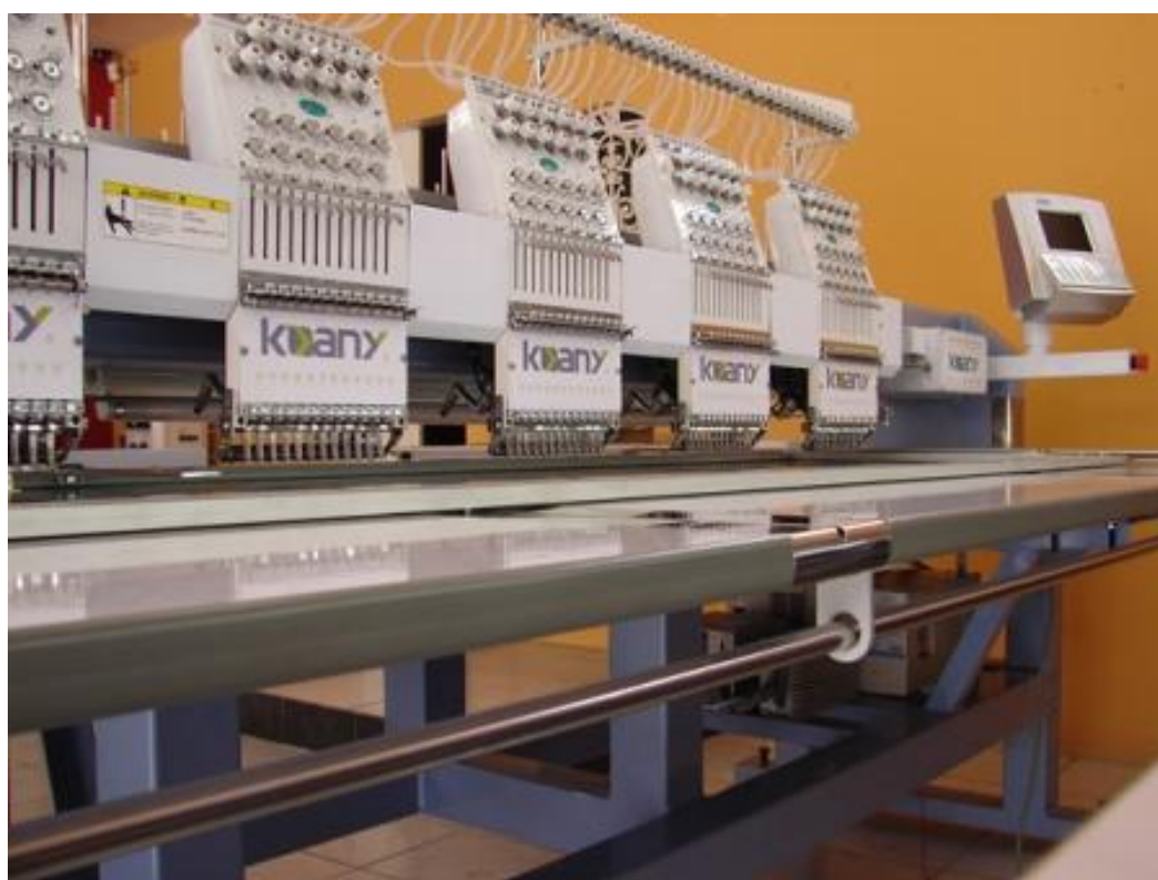
Figura 27- Máquina bordadeira industrial
