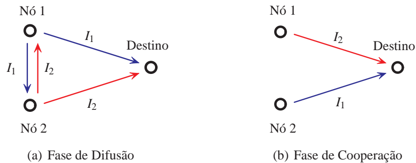
Figura 2.3: Rede cooperativa decodifica-e-encaminha com 2 nós cooperadores. (a) Cada nó difunde sua própria informação e (b) cada nó transmite a informação de seu parceiro após decodificá-la e recodificá-la.
